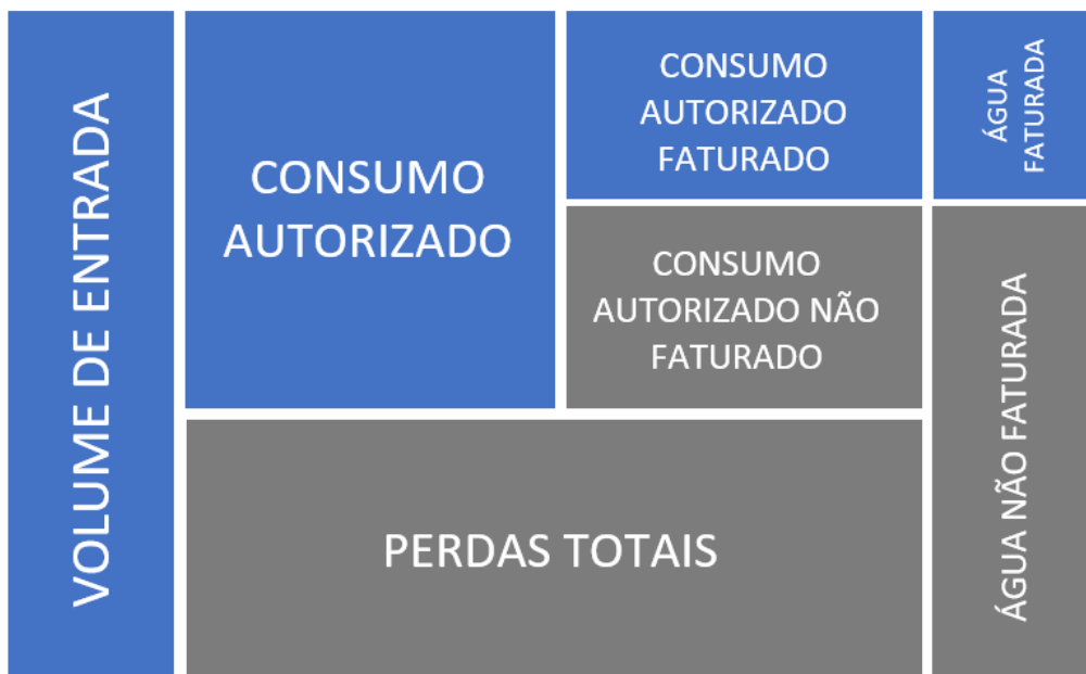
Figura 1 - Modelo de Balanço Hídrico Simplificado – IWA. Fonte: https://aesbe.org.br/novo/wp-content/uploads/2018/04/GUIA-5_V5.pdf
