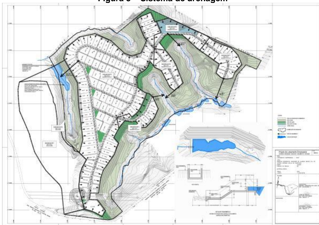
Figura 3 – Sistema de drenagem
