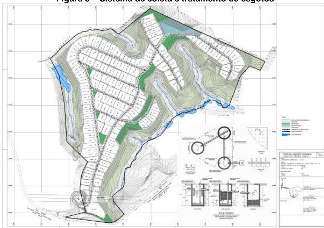
Figura 5 – Sistema de coleta e tratamento de esgotos
