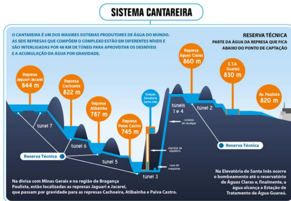
Figura 4: Interligação dos reservatórios que compõem o Sistema Cantareira.
