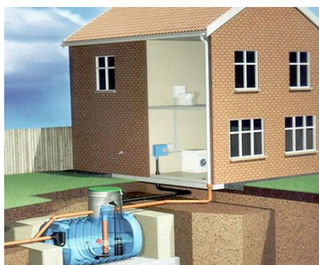
Figura 153. Captações de água de chuva para reuso
