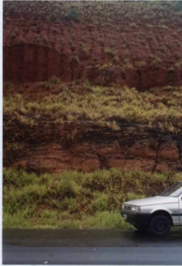
Foto 3. Solo de alteração de granulometria predominante arenosa sotoposto a arenitos com níveis conglomeráticos da Formação Marília rodovia Castelo Branco (SP-280), km 307, município de Itatinga
