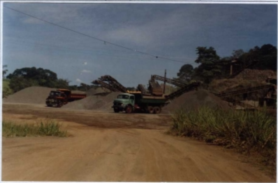
Foto 11. Pedreira Ws, de extração de brita (basaltos da Formação Serra Geral), localizada no município de Assis.
