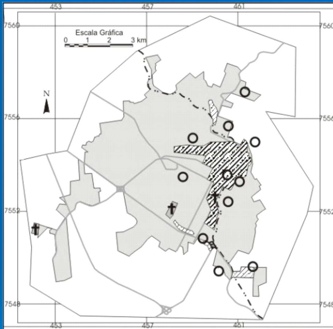
Figura 6. Localização de possíveis fontes de contaminação por \text{NO}_3^-
