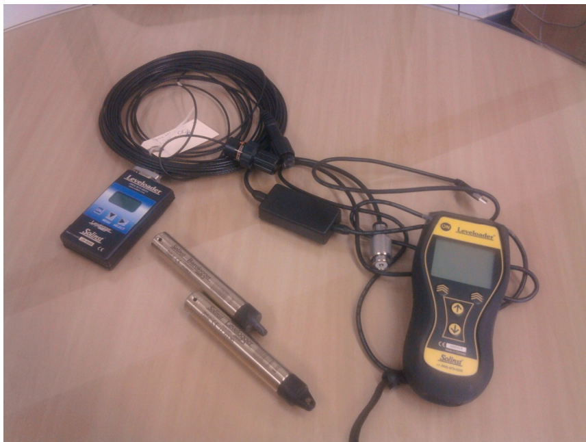
Sensor de nível fluviométrico com “data-logger”
