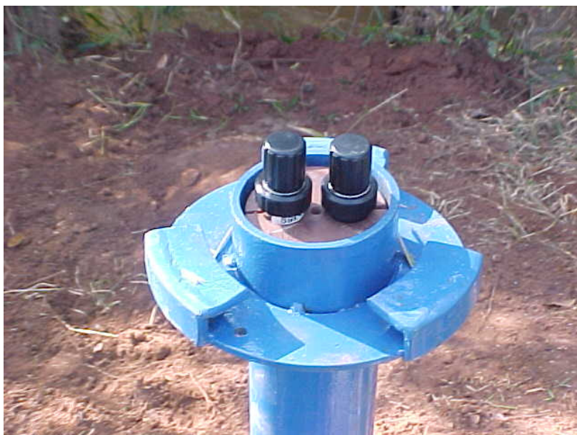
Sensor de nível piezométrico com “data-logger” instalado
