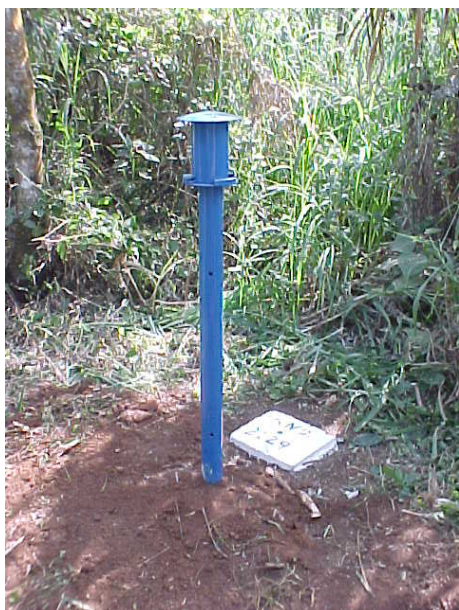
Sensor de nível piezométrico com “data-logger” instalado
