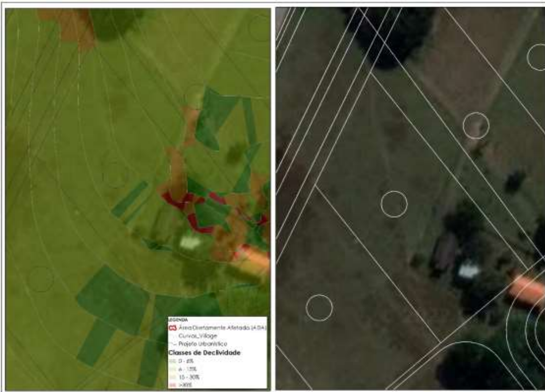
Figura 10.1.3.3-2: Lote 7 da Quadra XIII apresentando declividade >30% em decorrência de ocupação antrópica.
