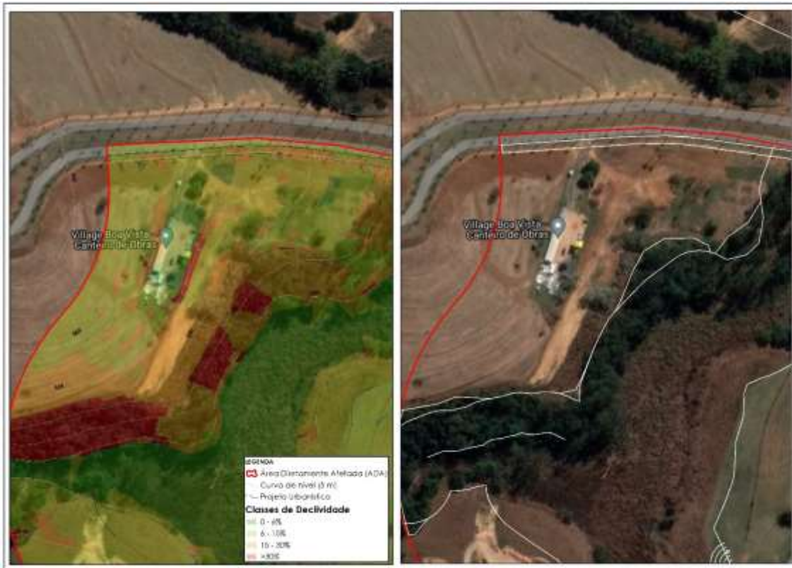
Figura 10.1.3.3-3: Lote Misto 3 apresentando declividade >30% em decorrência de ação antrópica para implantação de canteiro de obras. Destaca-se que limítrofe ao futuro lote há a ocorrência de declividades superiores a 30% associadas ao talvegue natural.
