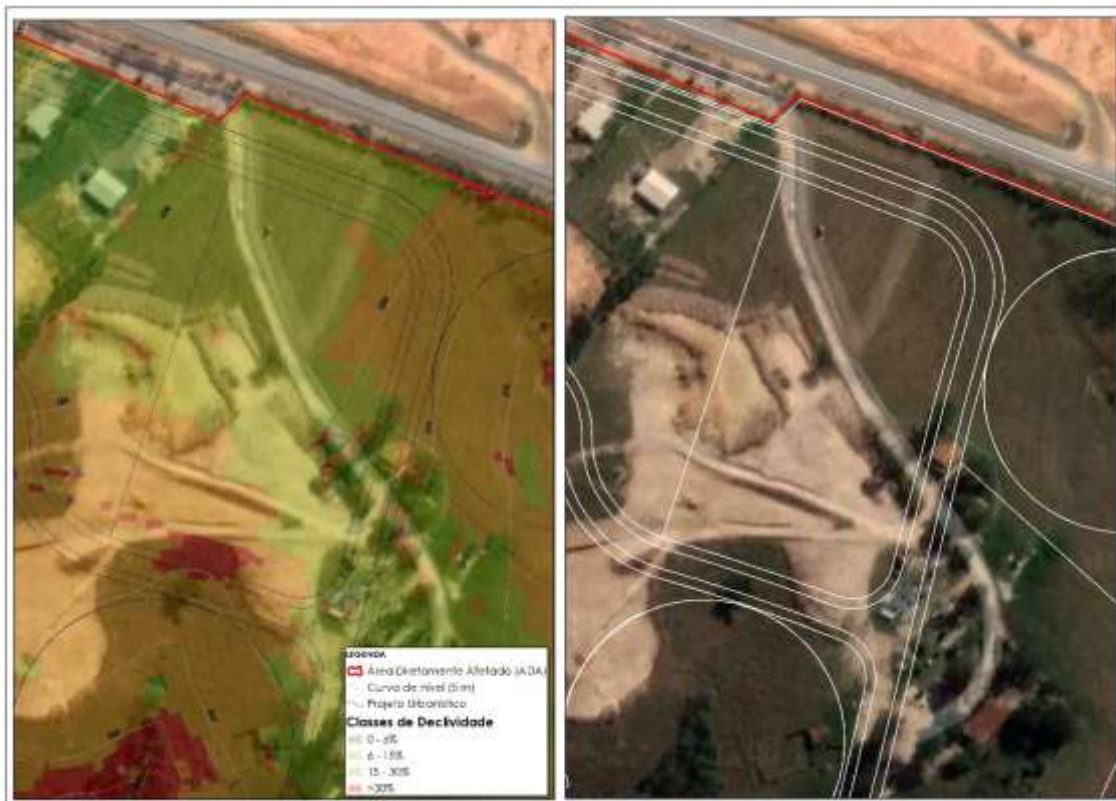
Figura 10.1.3.3-4: Lote Misto 10 inserido em área com atividades de corte e aterro.
